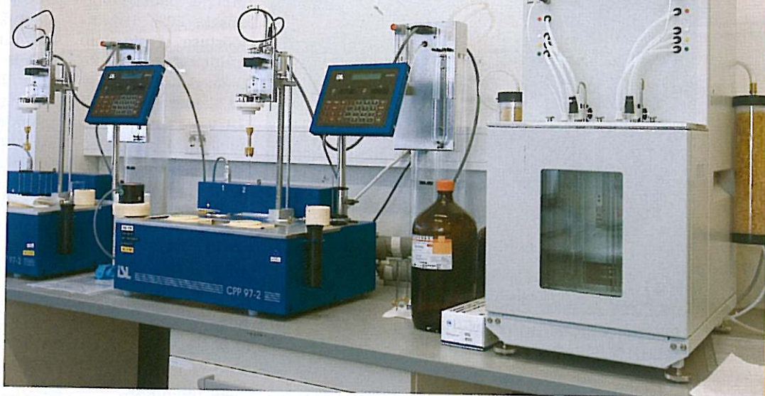
VISKOSIMEETER (PAREMPOOLNE SEADE) JA KAKS SEADET (VASAKUL) KÜTUSTE KÜLMUMISOMADUSTE (HANGUMISPUNKT, HÄGUSTUMISPUNKT, KÜLMFILTRI UMMISTUSPUNKT) MÄÄRAMISEKS
