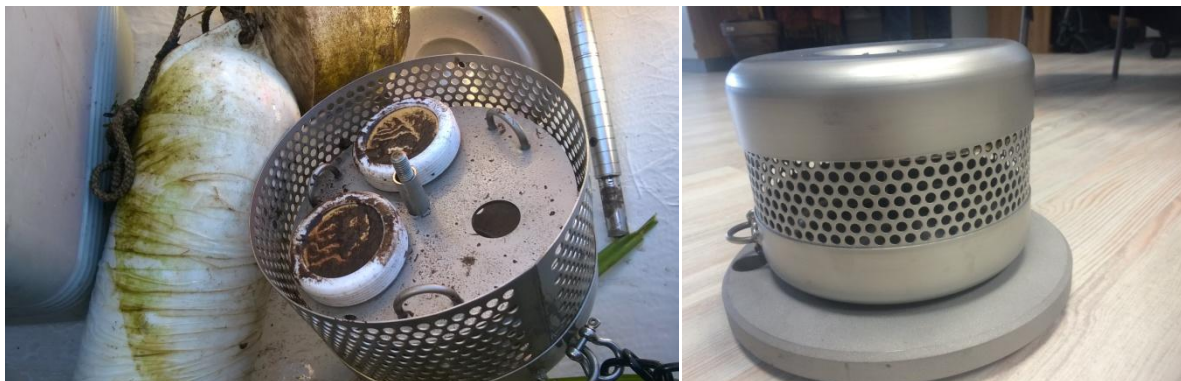
Joonis 6. Seade Chemcatcheri passiivsete proovivõtuseadmete paigaldamiseks veekogusse
