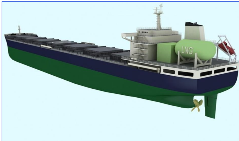
Joonis 2.4. Laeva tekil paikneva LNG mahutiga puistlastilaev (New LNG-fuelled...2012)
