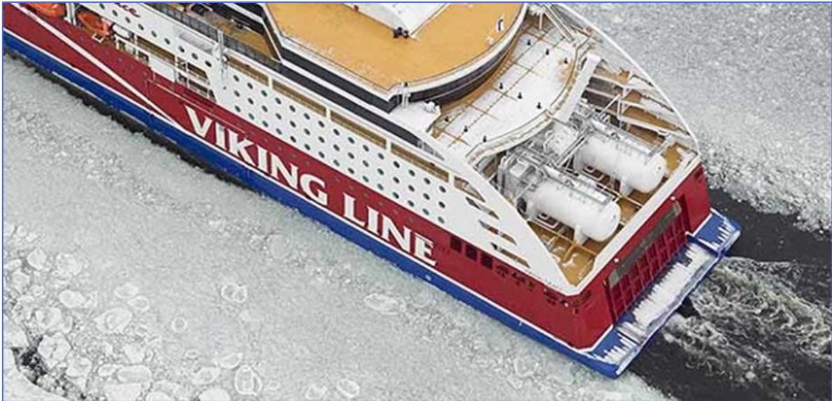
Joonis 2.5. Laeva tekil paikneva LNG mahutiga reisilaev „Viking Grace“ (Future marine...2015)
