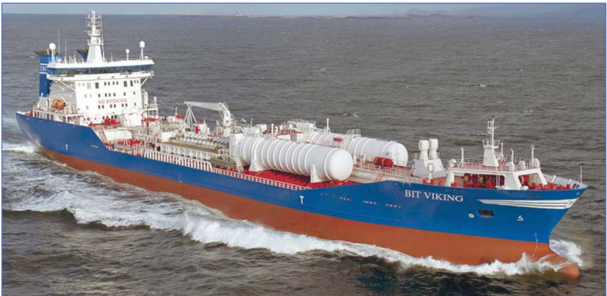
Joonis 2.6. Laeva tekil paikneva LNG mahutiga tanker „Bit Viking“ (Karlsson et al. 2012)
