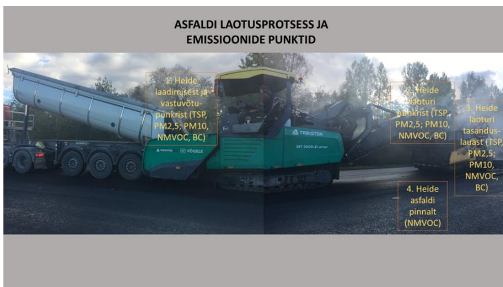
Joonis 19 Laotusprotsess ja heite mõõtepunktid
